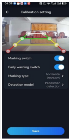
Calibration setting: Marking switch und Early warning switch ausschalten
